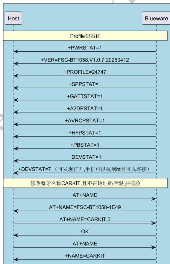
MCU 修改设备名 CARKIT 参考代码, 修改任何参数建议先查询再修改最后校验:
