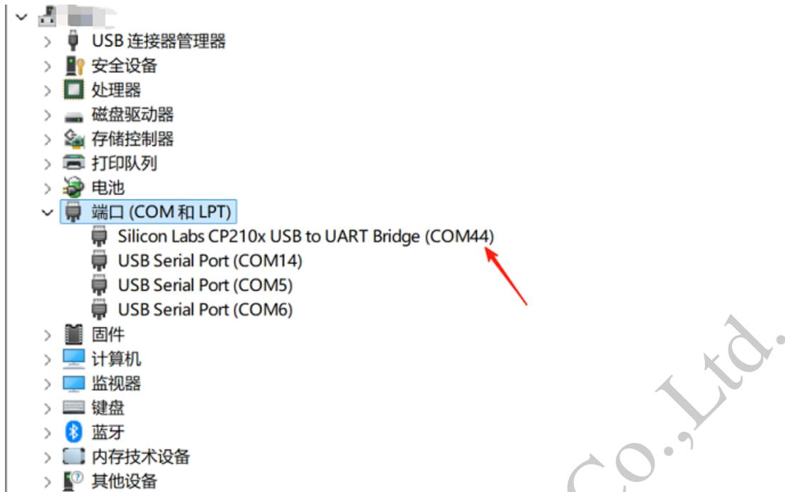
2. PC 端运行飞易通串口助手，设置正确的 串口号、波特率和 打开串口，并勾选 发送新行。如下图示：
