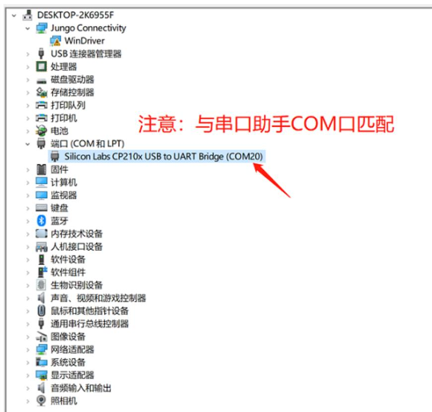
2.PC 端运行飞易通串口助手，设置正确的 串口号、波特率和 打开串口，并勾选 发送新行。
