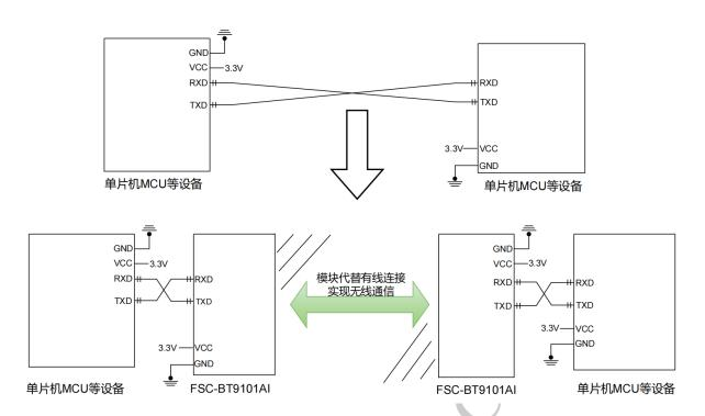
如图所示,蓝牙模块用于代替全双工通信时的物理连线。单片机 MCU 等设备(左)通过 TXD 给到蓝牙模块(左),蓝牙模块的 RXD 端口收到串口数据后,自动将数据以无线电波的方式经空中发送到远端蓝牙模块,远端蓝牙模块(右)接收到空中数据,并经 TXD 给到本地单片机 MCU 等设备(右)。
