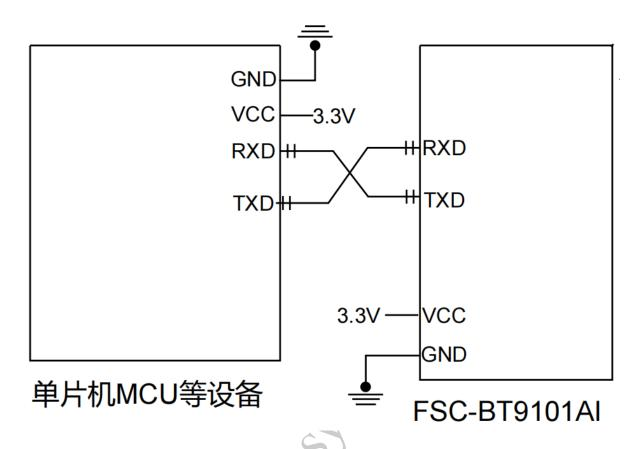
该图示展示了一个主控 MCU(微控制单元)和一个 FSC-BT9101AI 蓝牙模块连接示意图,通过串口交叉互联实现主控与蓝牙模块的指令交互,支持无线通信功能,适用于物联网设备、远程控制等场景。
